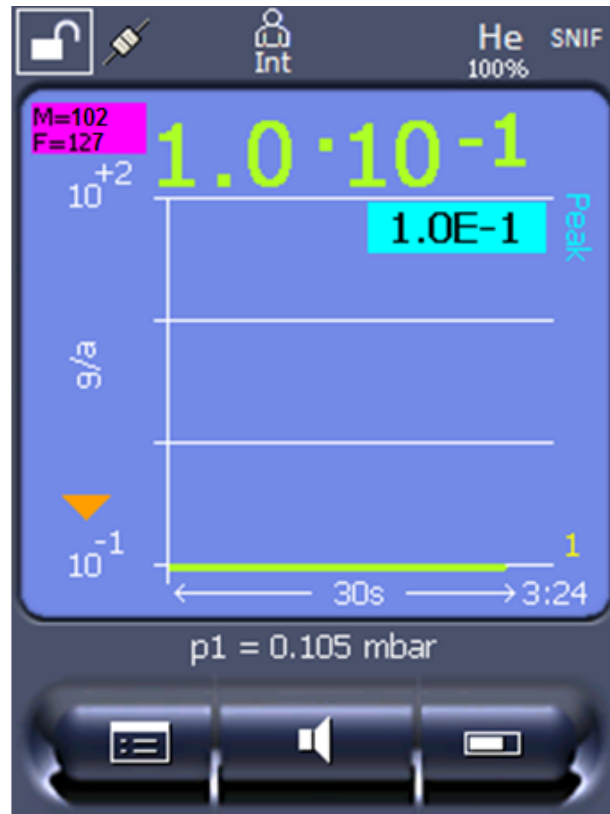
Fig. 8: Parte superior izquierda: visualización de la masa molar (102) y del factor de equivalencia (127)
