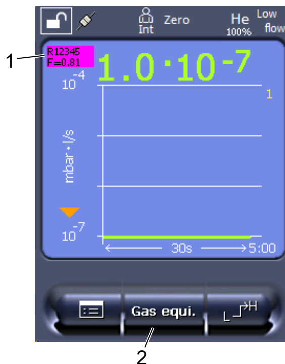
Fig. 7: Pantalla de medición con tasa de fuga equivalente visualizada y tecla de favoritos configurada
