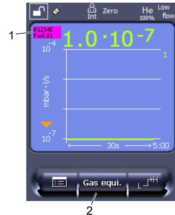
Fig. 3: Pantalla de medición con tasa de fuga equivalente visualizada y tecla de favoritos configurada
