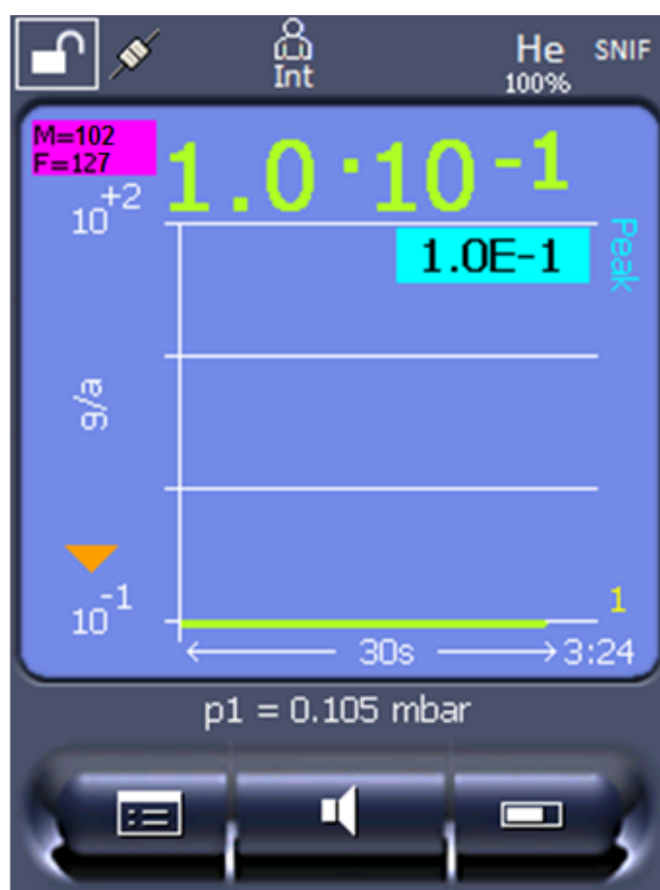
Fig. 4: Parte superior izquierda: visualización de la masa molar (102) y del factor de equivalencia (127)
