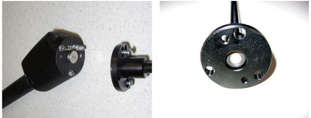
Fig. 19: Filtro sinterizado del mango de aspiración
