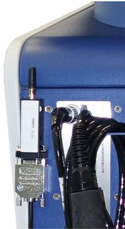
Fig. 22: El transmisor se puede fijar en un lugar libre con el velcro suministrado.
