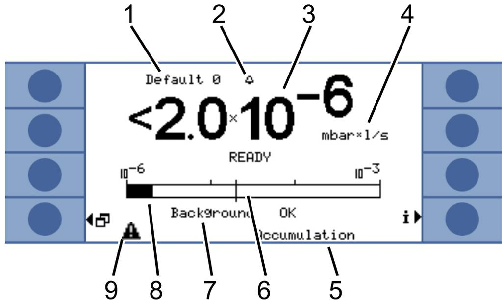
Fig. 17: Elementos de la pantalla de medición
