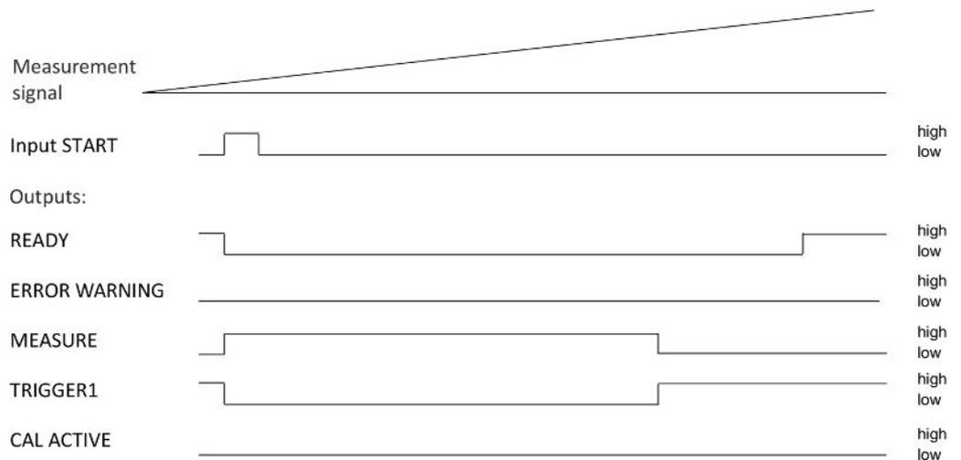
Fig. 28: Ejemplo de una medición de acumulación controlada mediante el PLC
