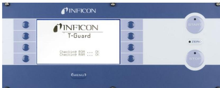
Fig. 5: Unidad de manejo para bastidor
