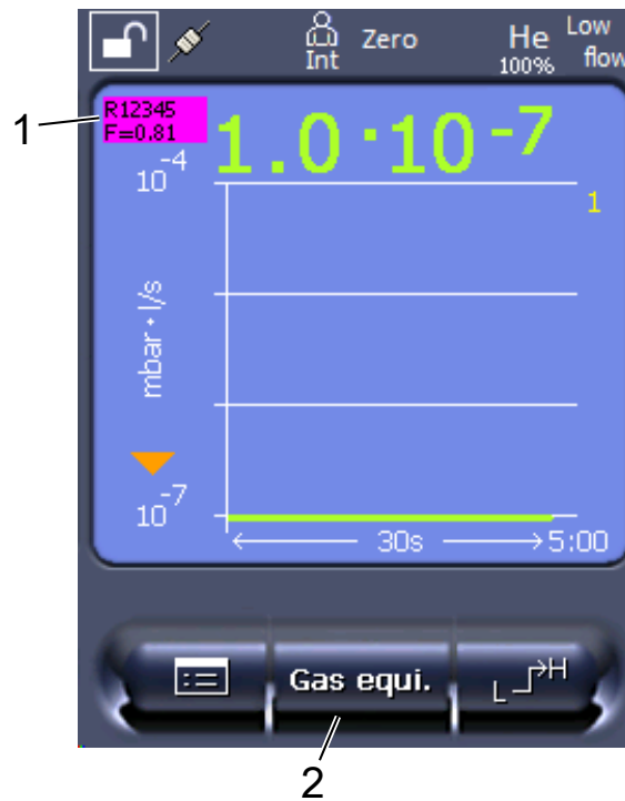
Fig. 23: Pantalla de medición con tasa de fuga equivalente visualizada y tecla de favoritos configurada
