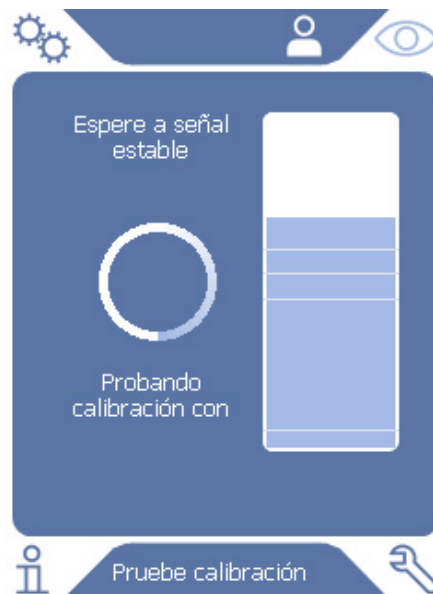
Fig. 12: Pantalla al calibrar internamente
