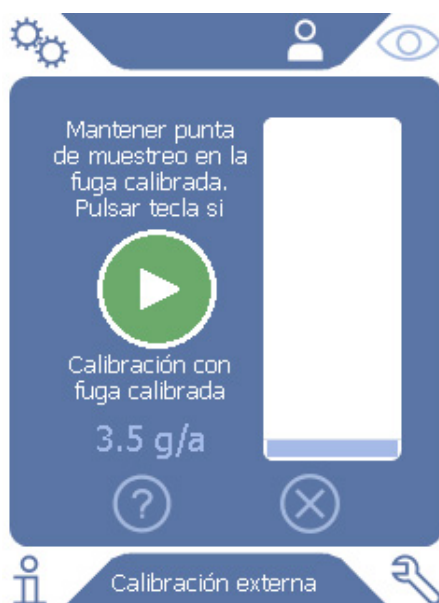
Fig. 13: Pantalla al efectuar una calibración externa
