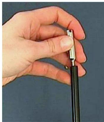
Fig. 8: Enroscar la punta de protección contra el agua
