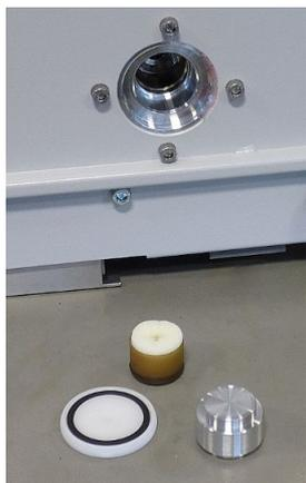
Fig. 48: Depósito de líquido de servicio abierto
