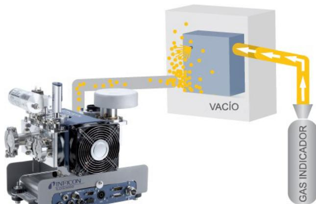
El uso del detector de fugas de helio [LDS3000](#) o [Modul1000](#) de INFICON garantiza una gran fiabilidad y repetibilidad de los resultados de las pruebas necesarias para la industria de bolsas de aire automotrices. Ambos detectores de fugas permiten llevar a cabo ciclos de pruebas rápidos y requieren un mantenimiento mínimo que garantizan un mayor tiempo de actividad de las estaciones de pruebas de fugas.
