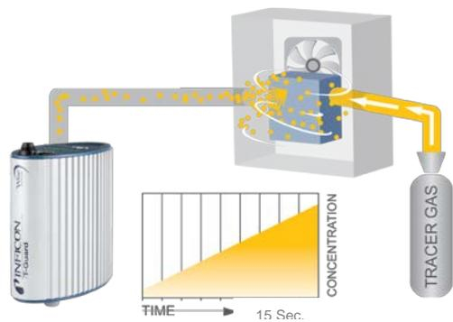
Los convertidores de par se pueden comprobar con baja inversión en un sistema de acumulación con el sensor de detección de fugas T-Guard.
