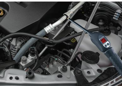
El detector de fugas Multi-Gas Ecotec E3000 es, actualmente, el único instrumento disponible que detecta cuantitativamente el refrigerante y el combustible al mismo tiempo — sin falsas alarmas procedentes de otros materiales (líquidos de limpieza, refrigerante, cierre hermético, etc.). Ecotec E3000 puede configurarse para detectar hasta cuatro gases diferentes al mismo tiempo,
