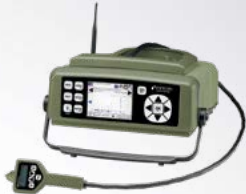
Sistema de identificación de sustancias químicas HAPSITE® ER
