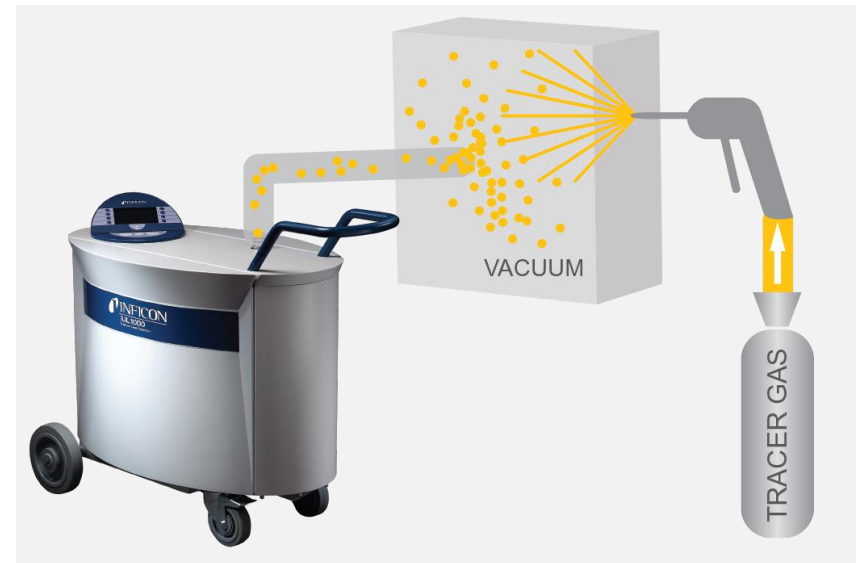
Prueba de estanqueidad por pulverización
