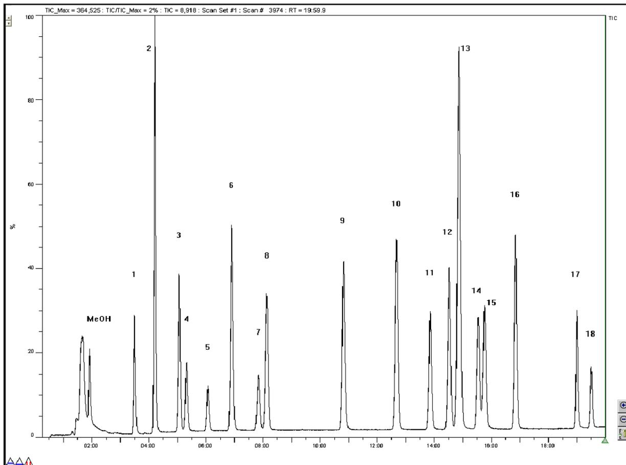
Column: HP-1MS, 30 m, 0.32 mm id, 4.0 µm df, Conc. Fill: 1 min.
