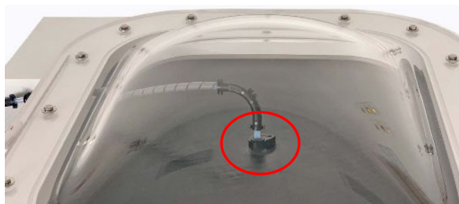
Fig. 6: Dispozitivul de prindere cu clichet pe partea superioară a camerei de măsură
