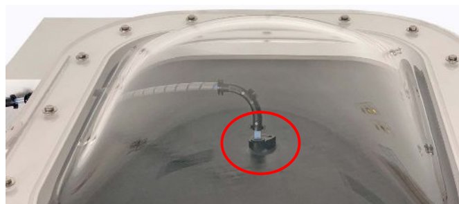
Fig. 6: Collier cranté sur le dessus de l'enceinte de mesure
