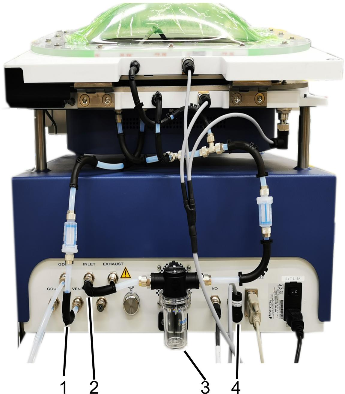
Fig. 3: Raccordement de la FTC3000 sur la GCU
