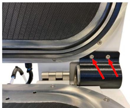
Fig. 13: Cache du ressort hélicoïdal
