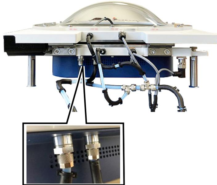
Fig. 7: Raccord fileté de tuyau, support de membrane inférieur
