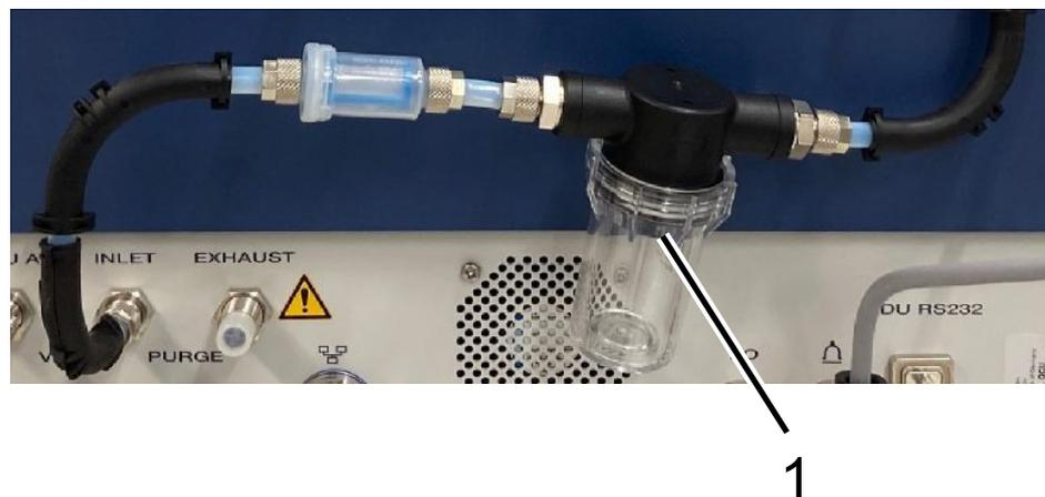
Fig. 10: Contrôler le séparateur de liquides
