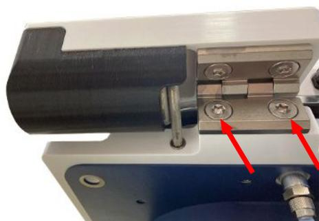
Fig. 14: Fissaggio al portamembrana inferiore
