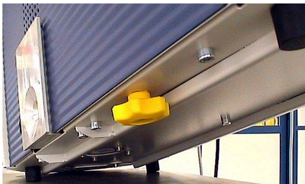
Рис. 5: Перед началом эксплуатации выкрутить жёлтый транспортировочный предохранительный элемент
