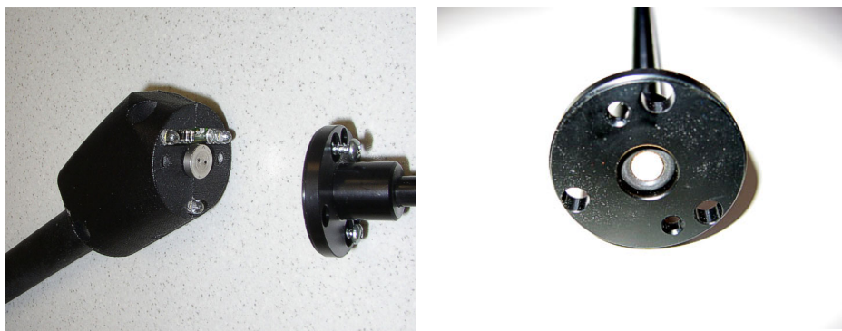
Рис. 55: Керамический фильтр в ручке-детекторе
