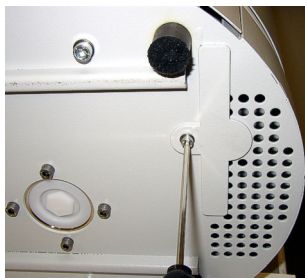
Рис. 46: Откручивание крышки воздушного фильтра
