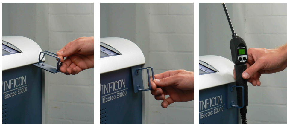
Рис. 9: Монтаж держателя детекторной линии
