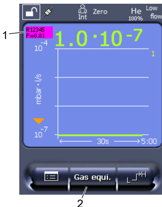
Rys. 3: Ekran pomiarowy z wyświetlaniem równoważnego wycieku i skonfigurowanym przyciskiem "Ulubione"
