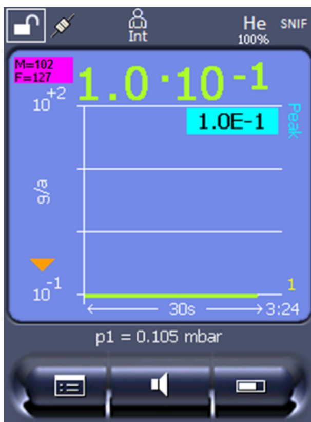
Rys. 4: W lewym górnym rogu: Wskazanie masy molowej (102) i współczynnika ekwiwalencji (127)
