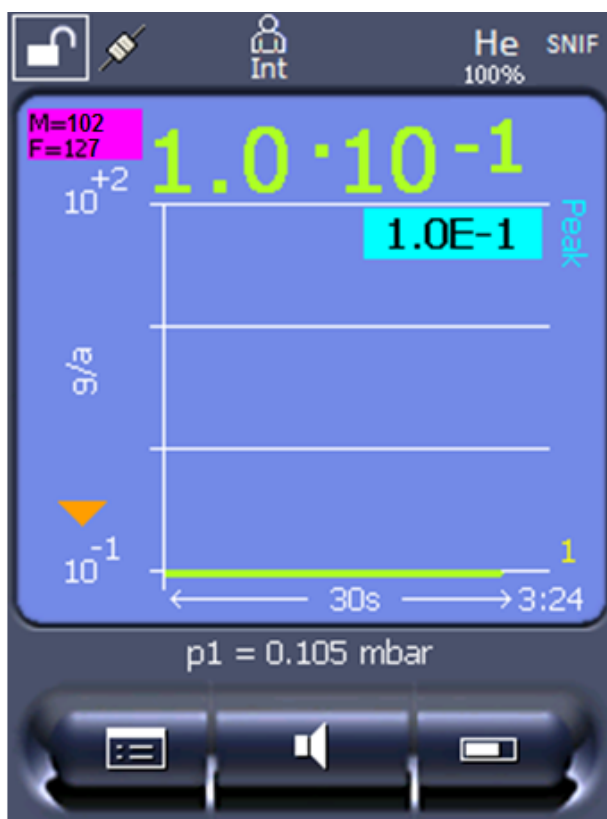
Obr. 4: Vlevo nahoře: Zobrazení molární hmotnosti (102) a faktoru ekvivalence (127)
