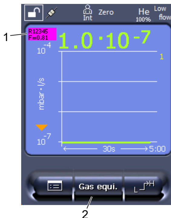
Obr. 3: Obrazovka měření se zobrazenou ekvivalentní mírou netěsnosti a nastaveným tlačítkem Favorité
