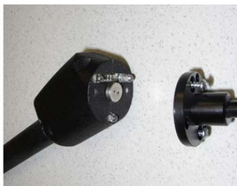
Rys. 20: Filtr spiekany w uchwycie sondy zasysającej
