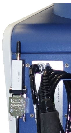
Rys. 22: Nadajnik można zamocować do wolnego miejsca za pomocą dołączonej taśmy z rzepem.
