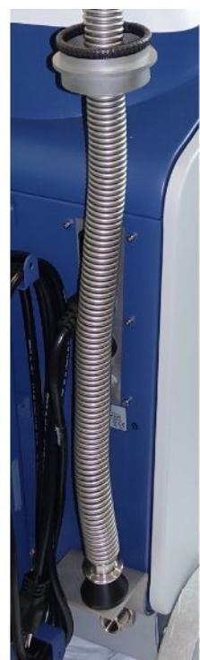
Рис. 9: Держатель гофрированного шланга установлен.
