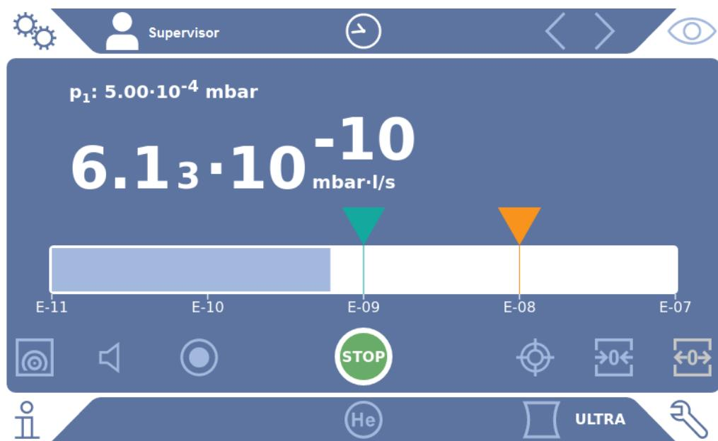
Рис. 12: Представление в качестве полосного индикатора
