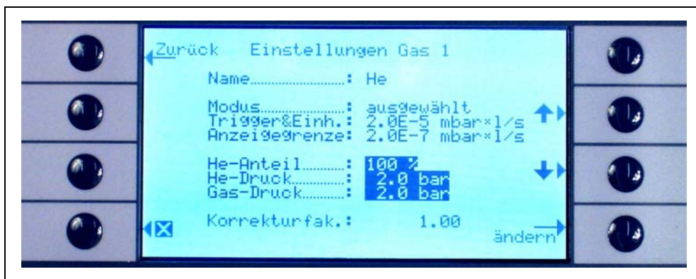
Obr. 43 Nastavení korekčního faktoru chladiva u plynů z knihovny plynů
