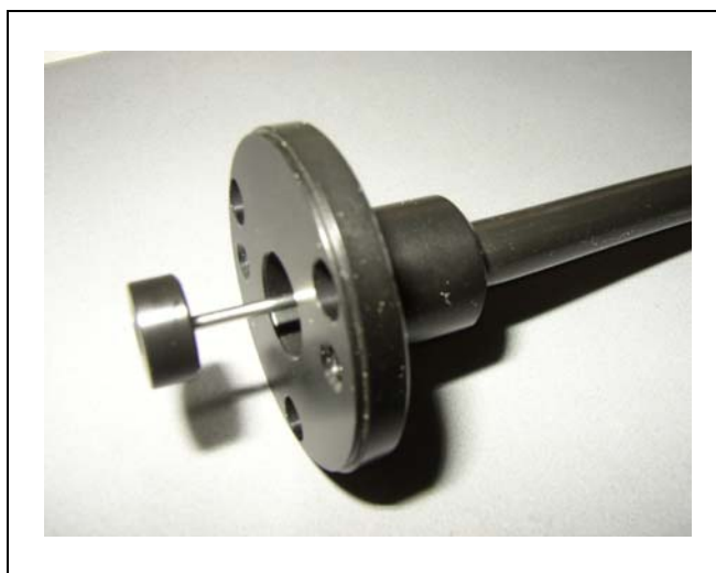
Obr. 84 Kapilára vyčnívající z příruby čichací špičky
