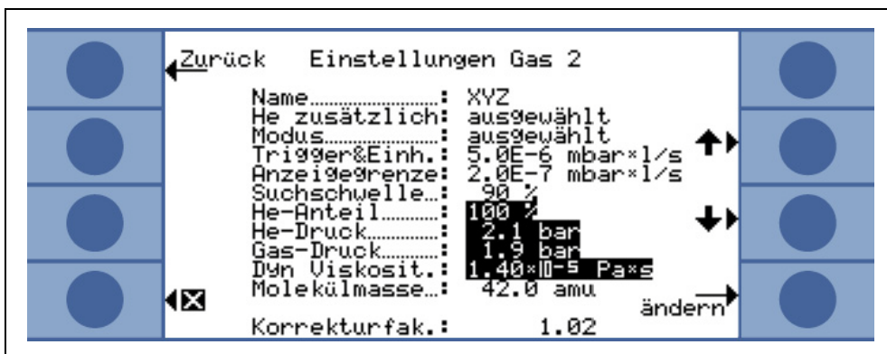
Obr. 44 Nastavení korekčního faktoru chladiva u plynu definovaného uživatelem
