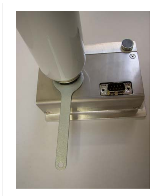
Obr. 87 Instalace zásobníku plynu
