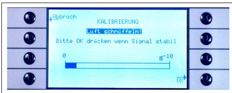
Obr. 37 Výzva k čichání vzduchu během externí kalibrace
