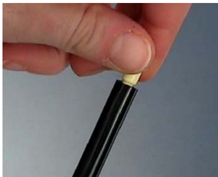
Obr. 73 Vyšroubování kapilárního filtru
