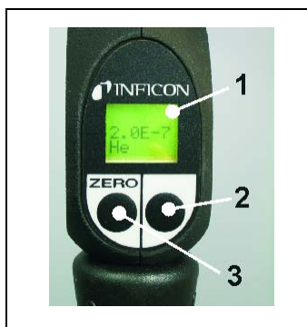
Obr. 12 Vedení čichací sondy s indikací sondy SL3000(XL)
