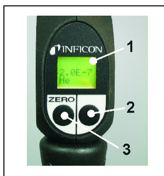
Obr. 11 Vedení čichací sondy s indikací sondy SL3000(XL)
