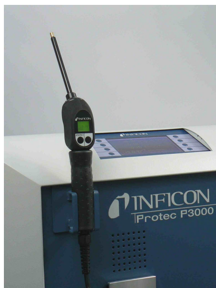
Obr. 6 Použití držáku vedení čichací sondy
