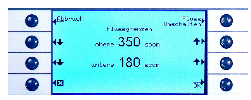
Obr. 49 Změna hranic průtoku pro vedení čichací sondy SL3000
