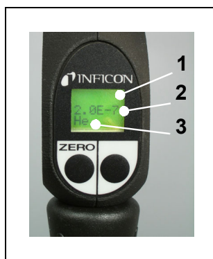
Obr. 20 Displej v rukojeti sondy ve standardním provozu
