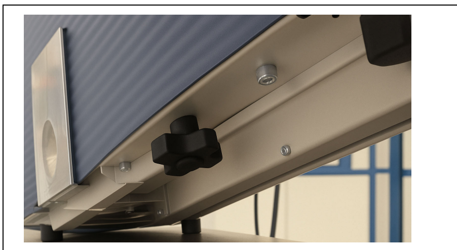
Obr. 2 Odstranění přepravního zajištění před uvedením do provozu
