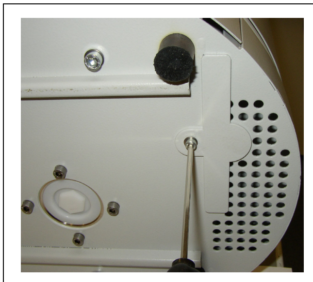
Obr. 69 Držák vzduchového filtru přístroje pro hledání netěsností
