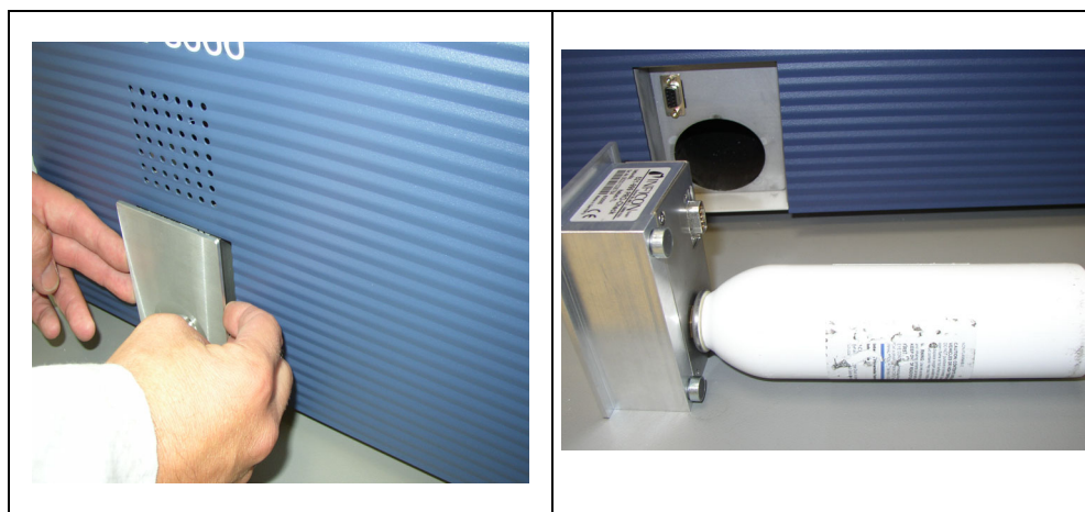
Obr. 84 Odejmутí referenční netěsnosti PRO-Check z hlavního přístroje
