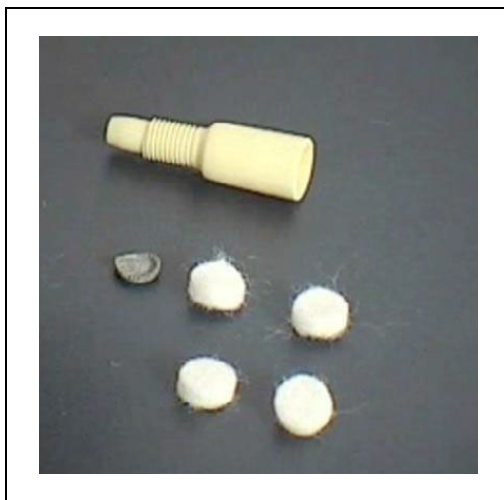
Obr. 74 Starý a nový filcový filtr
