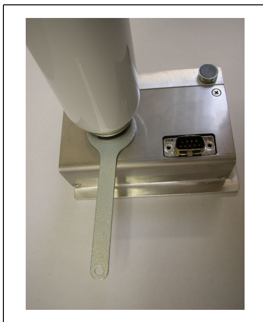
Obr. 86 Instalace zásobníku plynu
