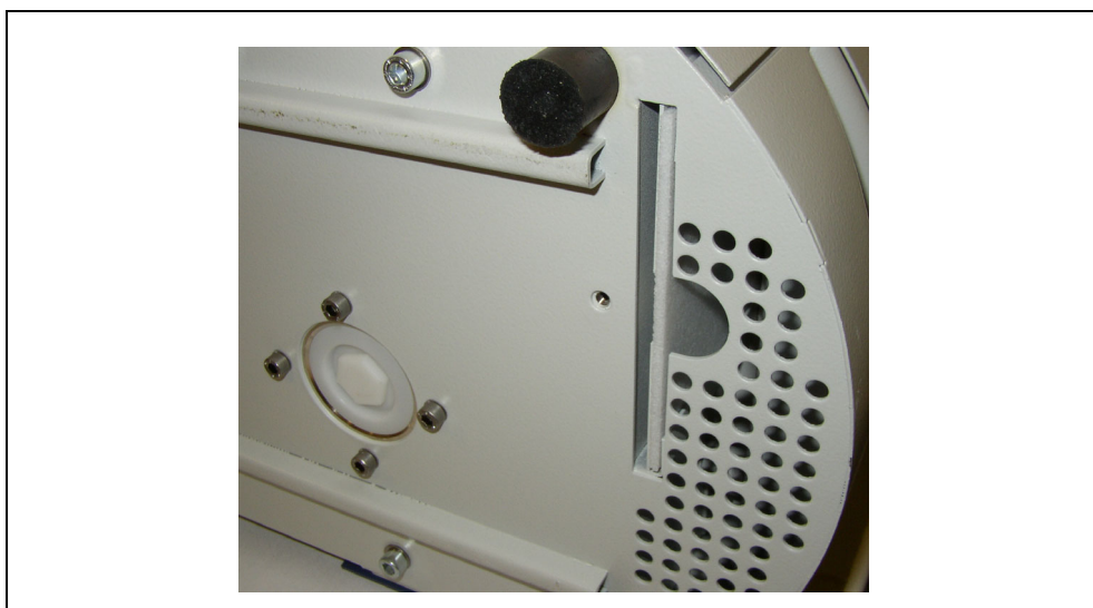
Obr. 70 Odstranění vzduchového filtru
