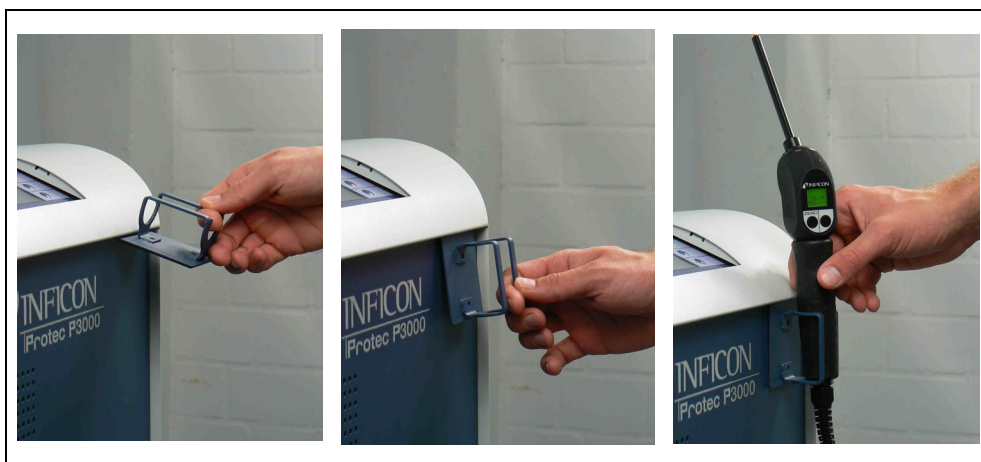
Obr. 7 Instalace držáku vedení čichací sondy
