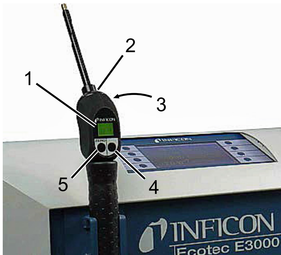
Obr. 4: Držadlo čichací sondy: Zobrazení a funkce
