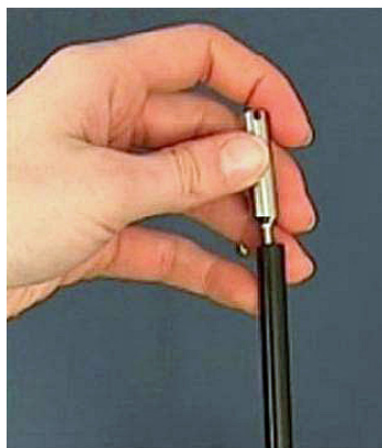
Obr. 8: Přišroubování násady proti nasání vody
