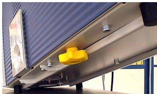
Obr. 5: Před uvedením do provozu vyšroubujte žluté přepravní zajištění
