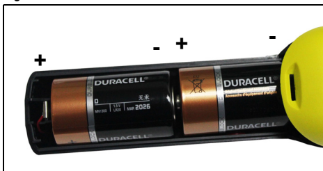
Figure 5 Piles alcalines installées correctement
