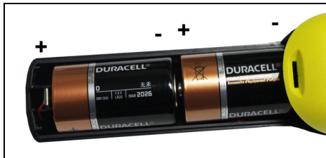
Figura 1 Pilas alcalinas instaladas correctamente
