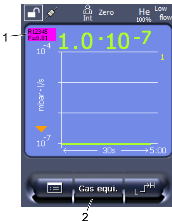
Fig. 3: Tela de medição com taxa de fuga de equivalência exibida e tecla de favoritos configurada
