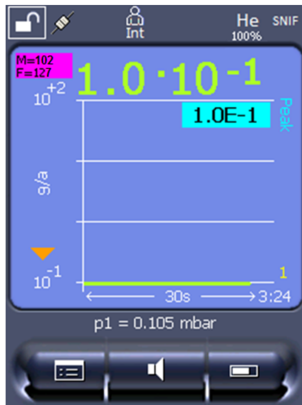
Fig. 4: Parte superior esquerda: Exibição da massa molar (102) e do fator de equivalência (127)
