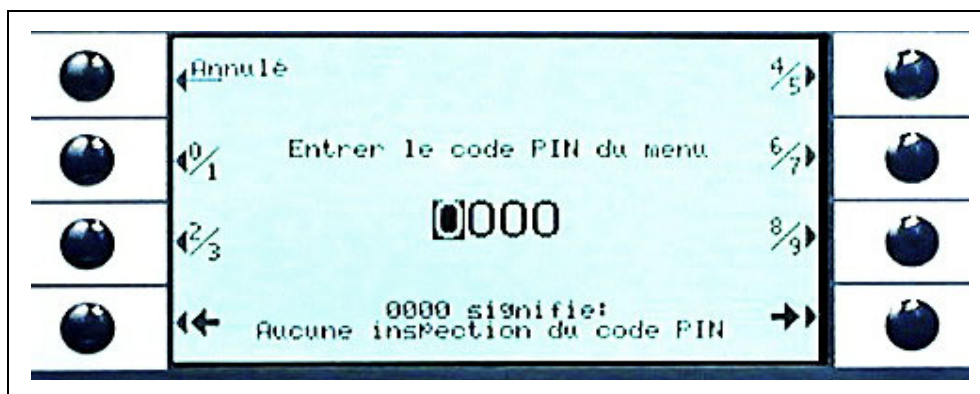
Fig. 52 Définition d'un code PIN du menu pour la protection des paramètres
