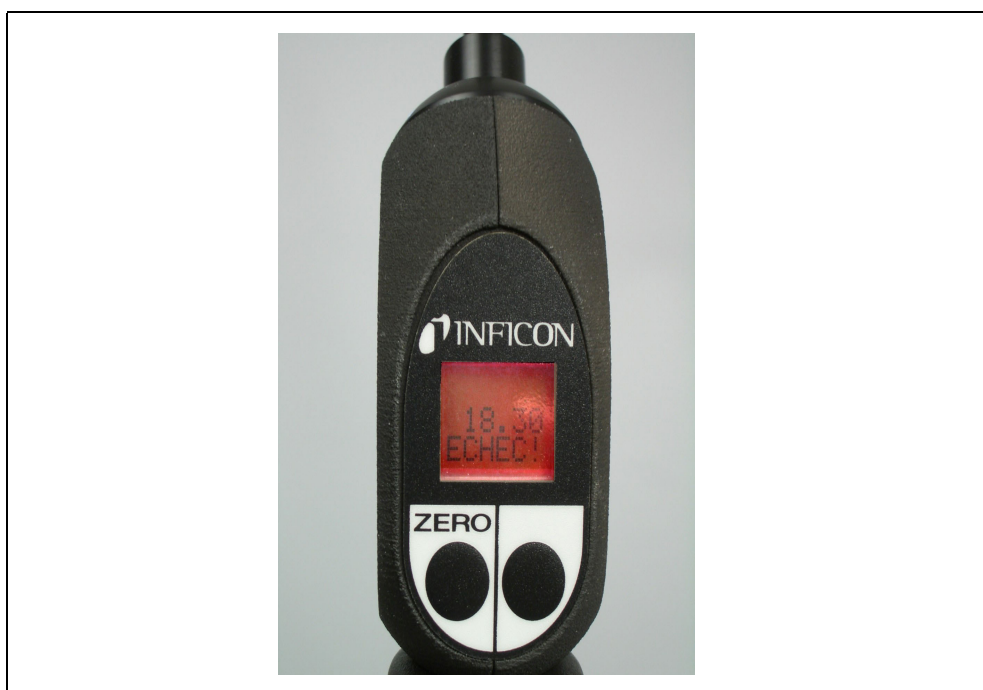
Fig. 21 Ecran de reniflard en cas d'identification d'une fuite
