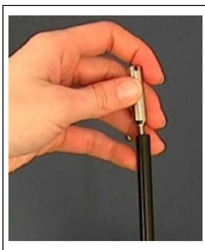
Fig. 3 Installation de l'embout de protection contre l'eau
