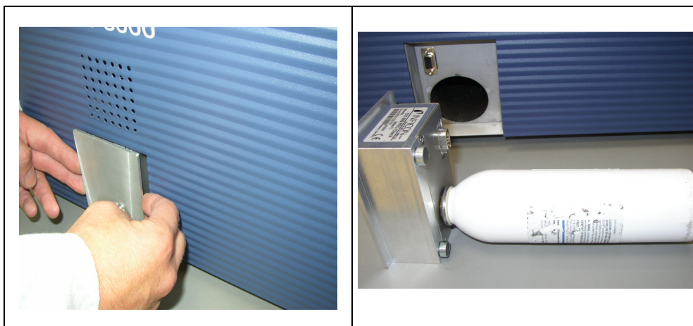
Fig. 83 Retrait de la fuite de référence PRO-Check de l'avant de l'unité principale
