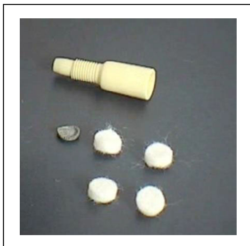
Fig. 73 filtres en feutre neufs et utilisés
