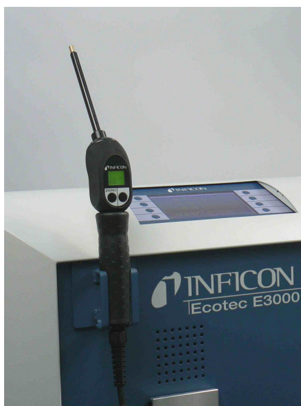
Fig. 6 Utilisation du support pour conduite de reniflage
