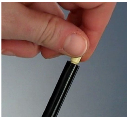
Fig. 71 dévissage du filtre capillaire
