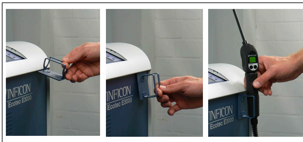
Fig. 7 Installation du support de conduite de reniflage
