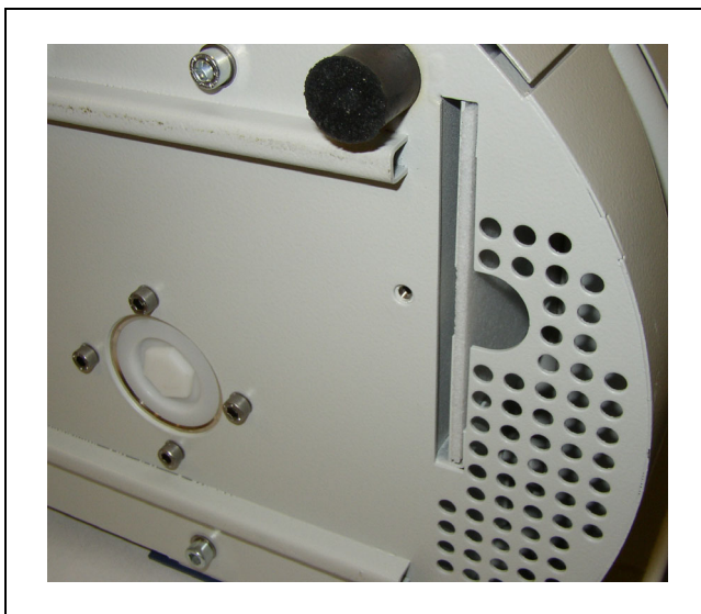
Fig. 69 Démontage du filtre à air
