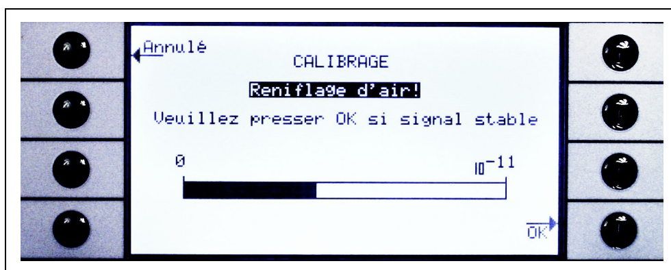
Fig. 36 Demande de reniflage de l'air pendant le calibrage externe
