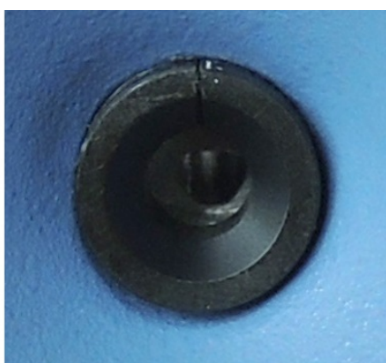
Fig. 10: Inserir anilha de centragem
