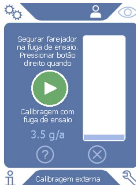
Fig. 13: Tela na calibragem externa
