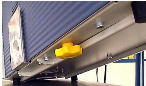
Fig. 5: Solte o parafuso de transporte amarelo antes da colocação em operação
