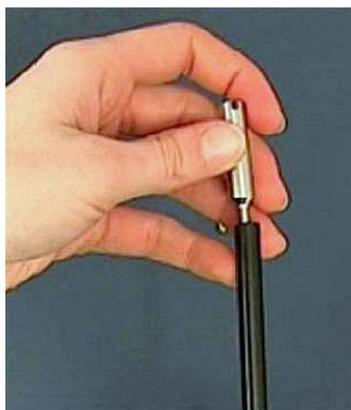
Fig. 8: Parafusar e apertar a ponteira antiágua
