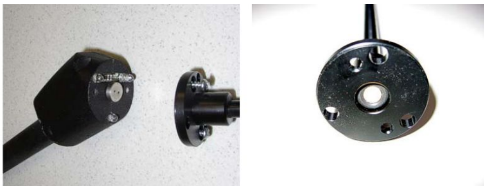
Fig. 19: Filtro di sinterizzazione nell'impugnatura sniffer
