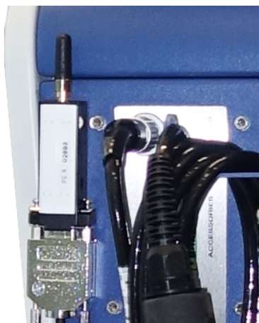
Fig. 21: Fissaggio del trasmettitore con nastro velcro in un punto libero
