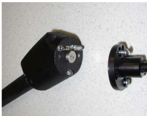
Rys. 19: Filtr spiekany w uchwycie sondy zasysającej
