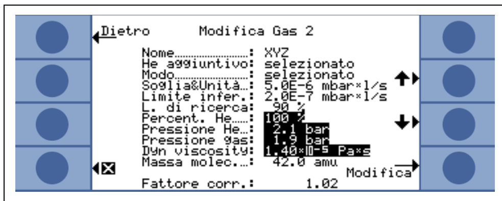
Fig. 44 Impostazione di un fattore di correzione del refrigerante con gas definito dall'utente
