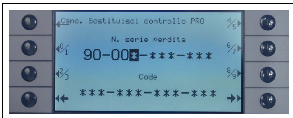
Fig. 5 Inizializzazione della fuga campione PRO-Check
