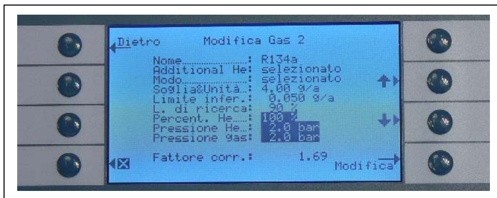
Fig. 43 Impostazione di un fattore di correzione del refrigerante con gas dalla biblioteca gas
