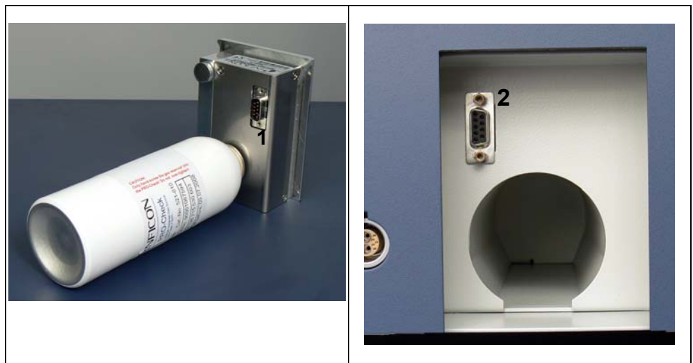
Fig. 16 Connessioni per uso remoto
