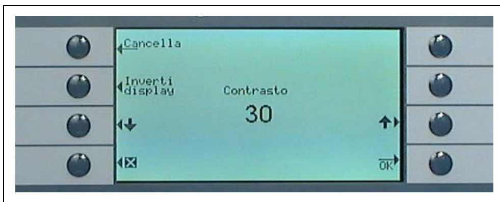
Fig. 54 Come configurare il contrasto del display principale
