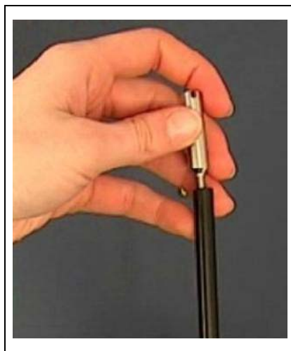
Fig. 4 Installazione del puntale di protezione dell'acqua
