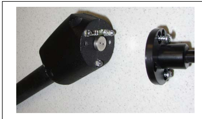
Fig. 76 Smontare il puntale dell'annusatore
