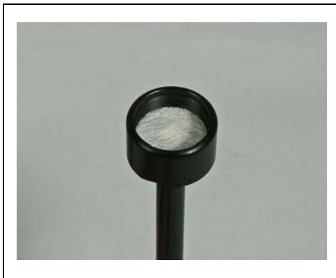
Fig. 80 Pad filtro nel dado del cappuccio
