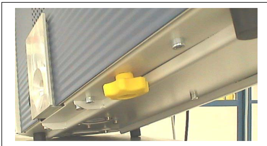
Fig. 3 Rimozione del fermo da trasporto prima dell'avvio
