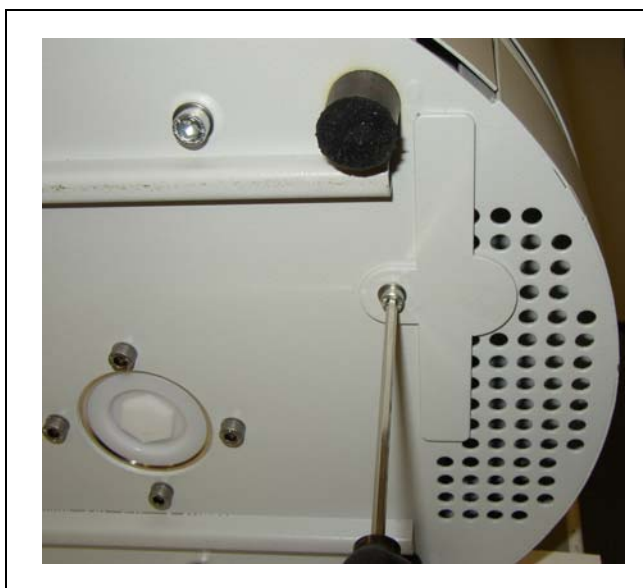
Fig. 69 Il fermo del filtro dell'aria si trova in basso sul rilevatore di fughe
