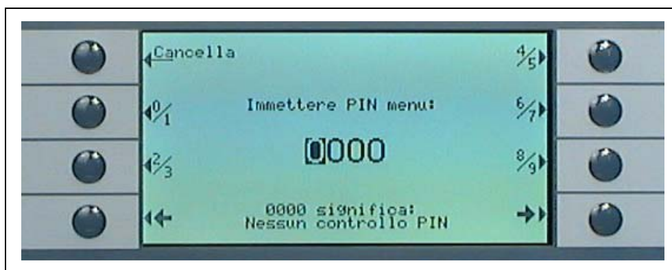
Fig. 53 Impostazione di un PIN del menu per la protezione dei parametri
