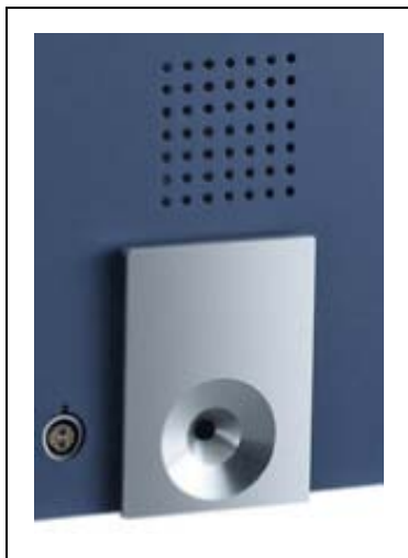
Fig. 14 Fuga campione PRO-Check integrata
