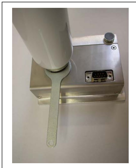
Fig. 87 Installazione del serbatoio di gas
