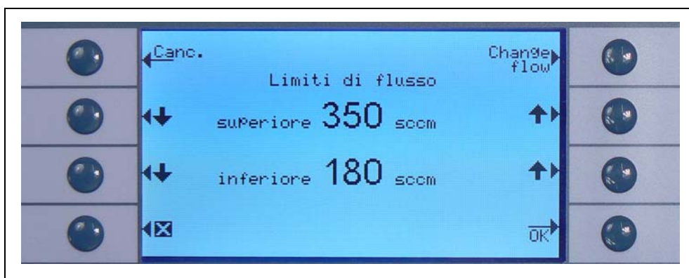
Fig. 49 Come modificare i limiti del flusso della linea dello sniffer SL3000
