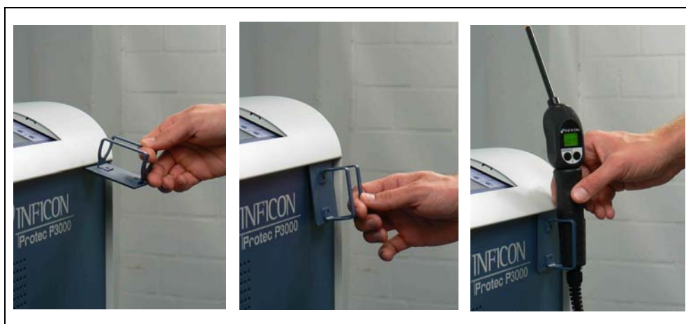
Fig. 8 Uso della supporto della linea sniffer
