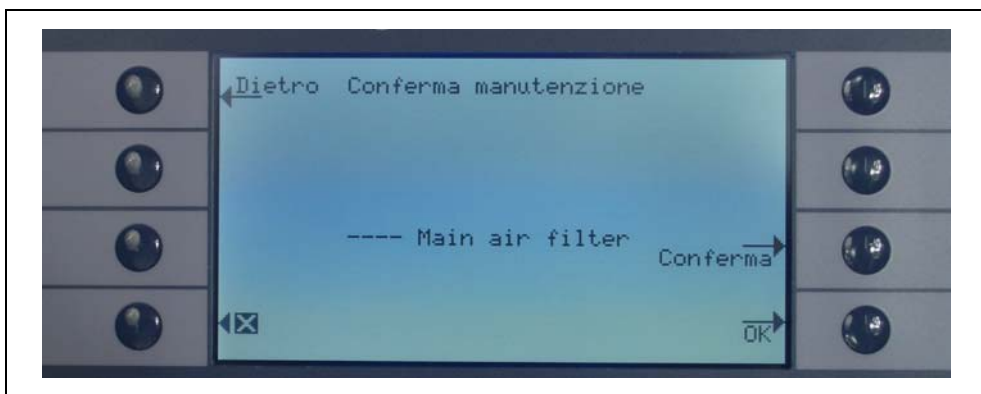
Fig. 64 Conferma dei task di manutenzione
