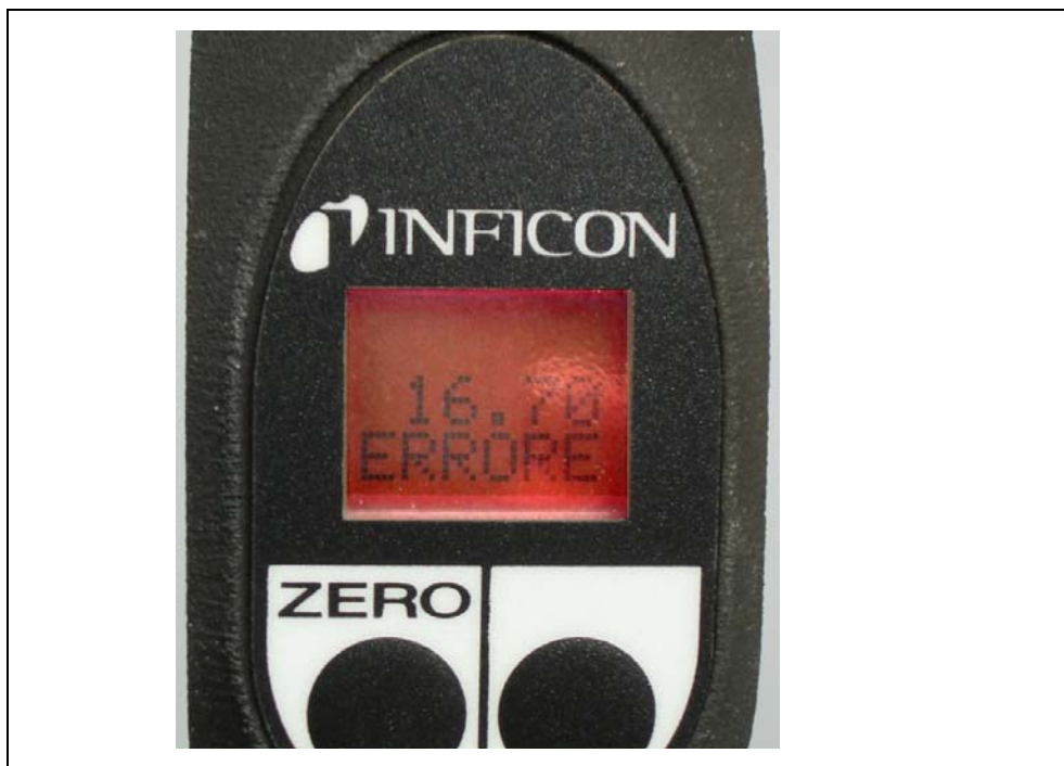
Fig. 21 Display dello sniffer quando si rileva una fuga
