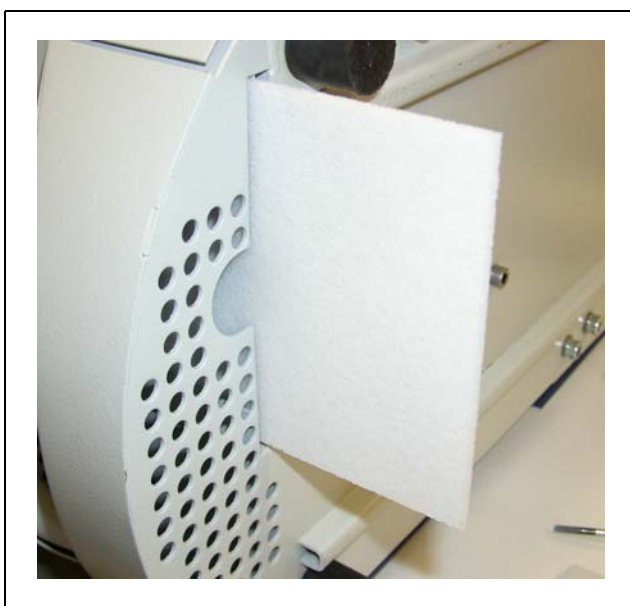
Fig. 71 Inserimento del materassino filtrante
