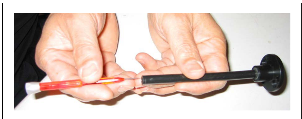
Fig. 83 Estrazione del filtro capillare
