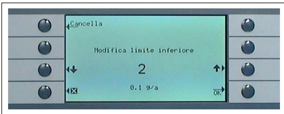
Fig. 47 Modifica del limite di visualizzazione inferiore
