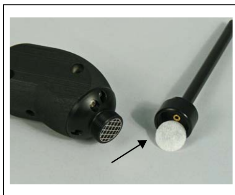
Fig. 79 Rimuovere il pad del filtro
