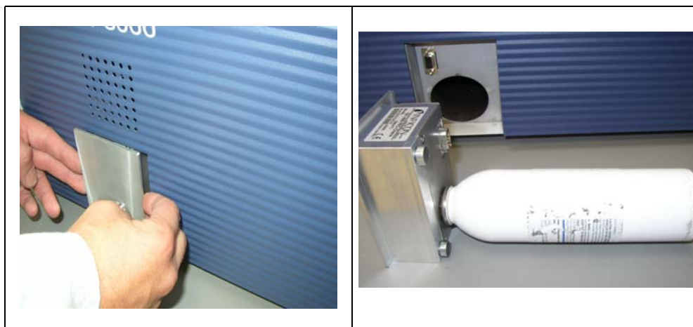
Fig. 85 Rimozione del campione di fuga PRO-Check dall'unità principale
