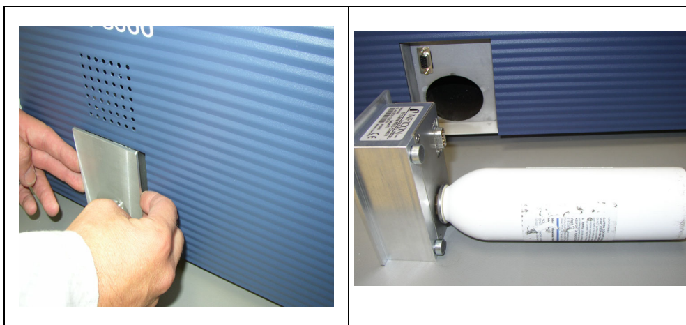
Fig. 84 Rimozione del campione di fuga PRO-Check dall'unità principale
