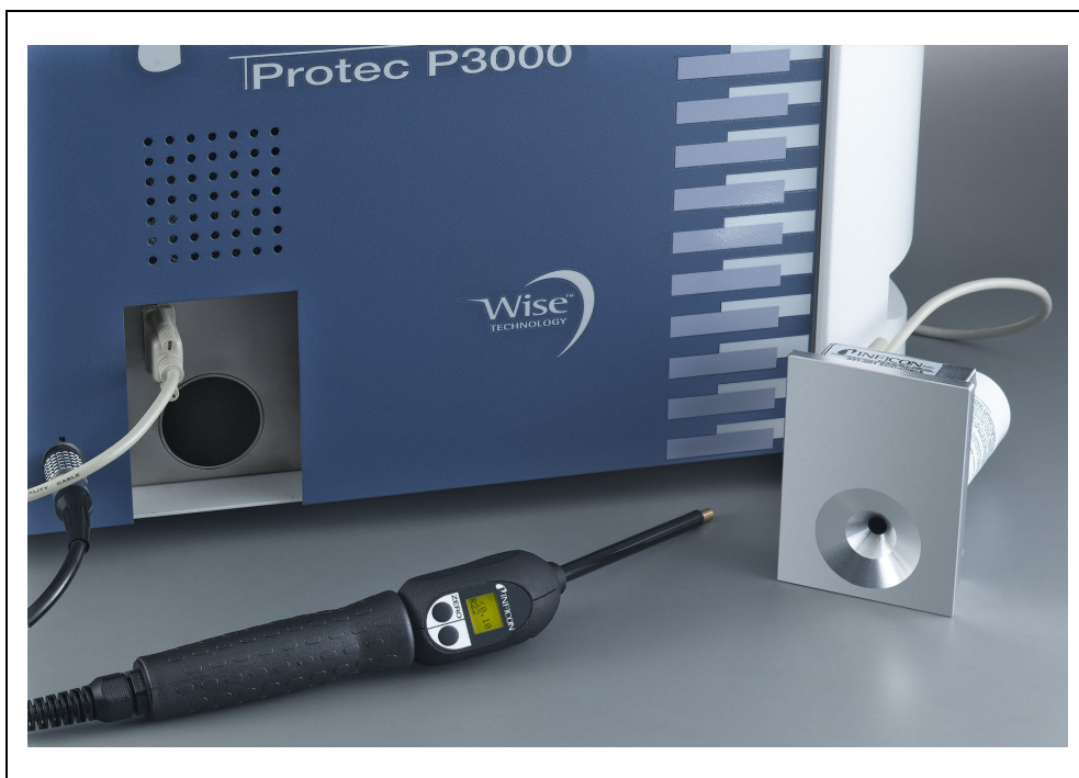
Fig. 14 PRO-Check separata dall'unità principale per impiego remoto
