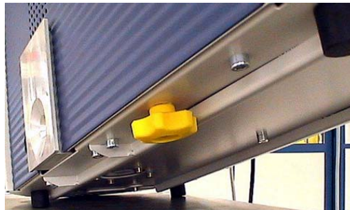
Fig. 5: Dévissez le dispositif de sécurité de transport jaune avant la mise en service
