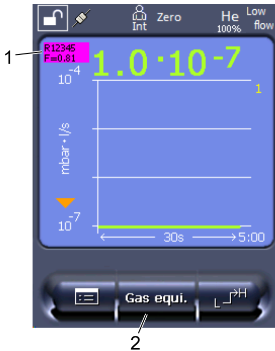
Fig. 3: Écran de mesure avec taux de fuite d'équivalence affiché et touche de favori activée
