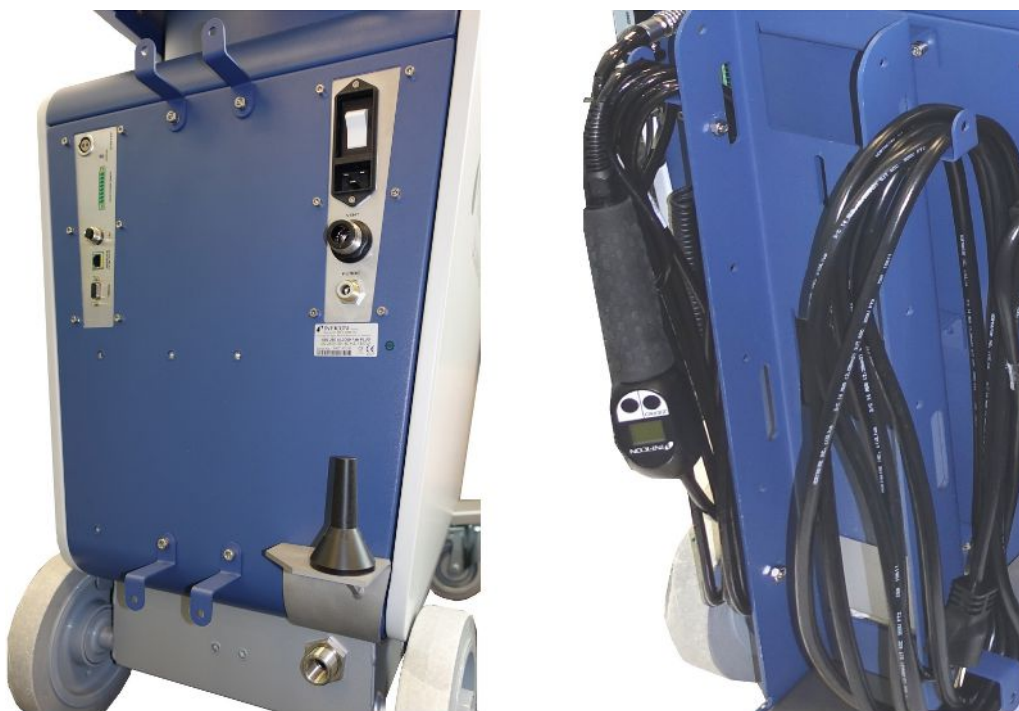
Fig. 8: Crochets sur l'instrument ou sur le porte-bouteille en option
