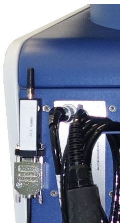
Fig. 22: Le transmetteur peut être fixé sur un emplacement vide à l'aide des bandes adhésives fournies.
