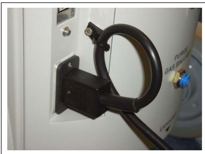
Fig. 2-4 Afin d'éviter que le câble ne soit débranché par inadvertance, il est peut être sécurisé de la manière indiquée sur la figure
