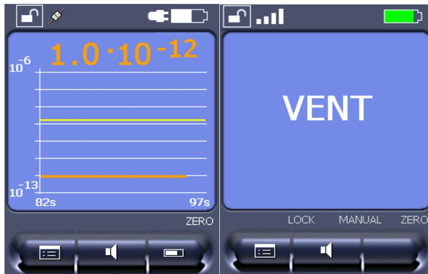
Fig. 29: „Measure“ (curve) and „Vented“ status displays
