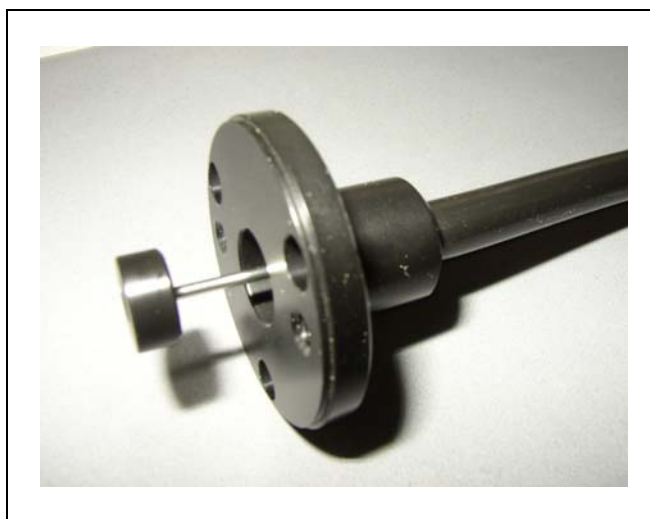
Fig. 84 Stalowa kapilara wystająca z kołnierza końcówki czujnika
