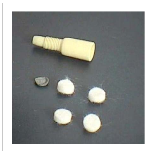
Fig. 75 Stara i nowa wkładka filcowa
