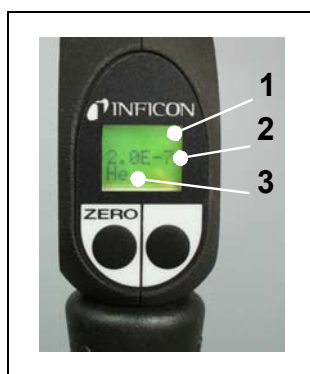
Fig. 20 Wyświetlacz na uchwycie w trybie standardowym
