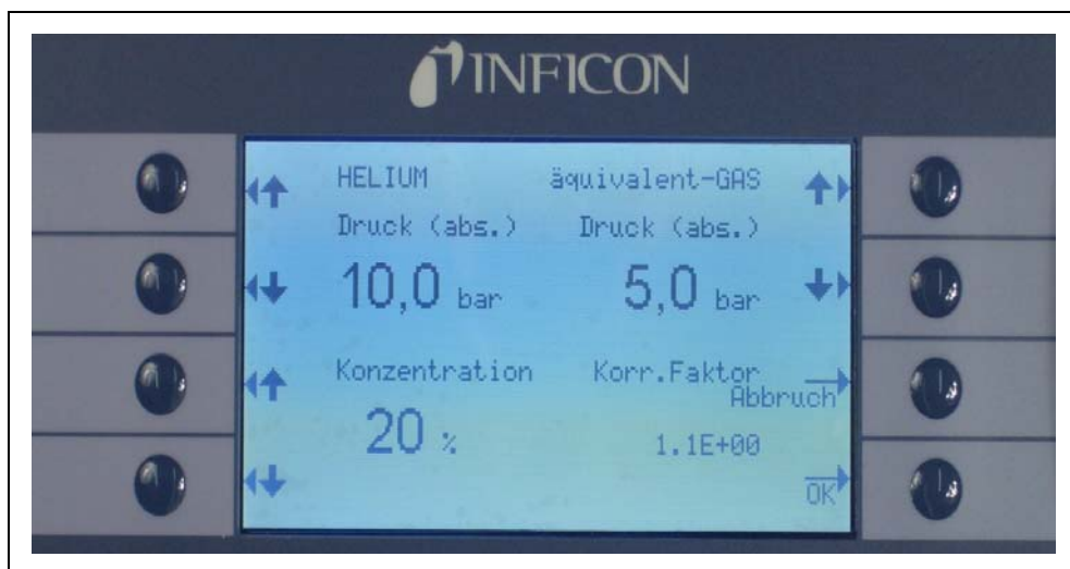
Fig. 45 Edytowanie parametrów dla wartości nieszczelności zamienników chłodziwa
