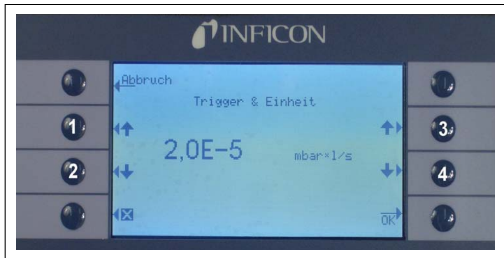
Fig. 46 Ustawianie poziomu wyzwalania oraz jednostki (Trigger & Einheit) pomiaru
