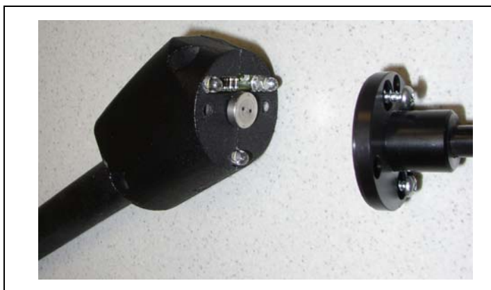
Fig. 76 Demontaż końcówki czujnika
