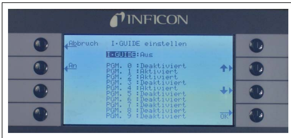
Fig. 56 Ustawianie trybu I•Guide (I•Guide einstellen)
