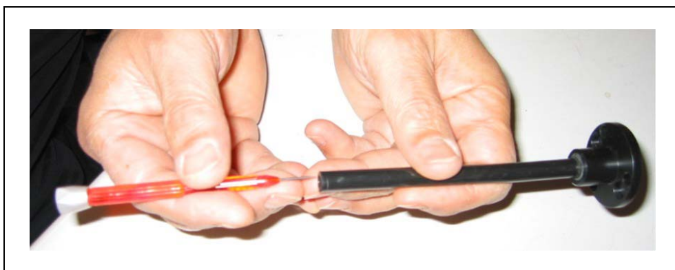
Fig. 83 Wypychanie stalowej kapilary
