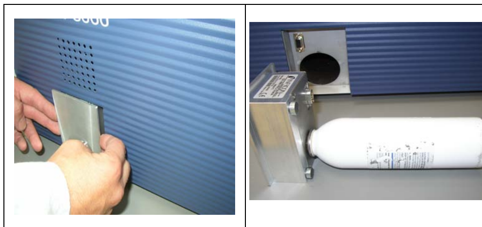
Fig. 85 Demontaż nieszczelności referencyjnej PRO-Check z urządzenia głównego
