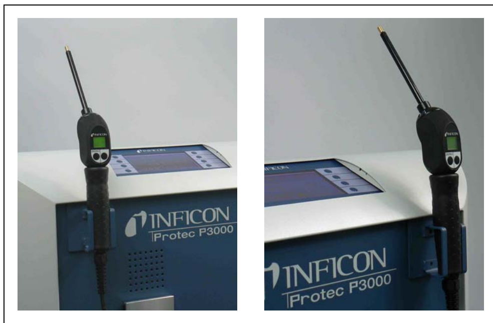
Fig. 7 Używanie uchwytu dla sondy
