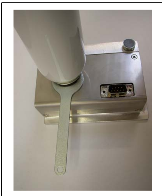
Fig. 87 Montaż pojemnika na gaz
