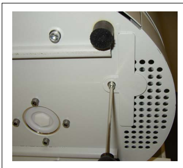
Fig. 69 Mocowanie filtra powietrza na spodzie detektora nieszczelności
