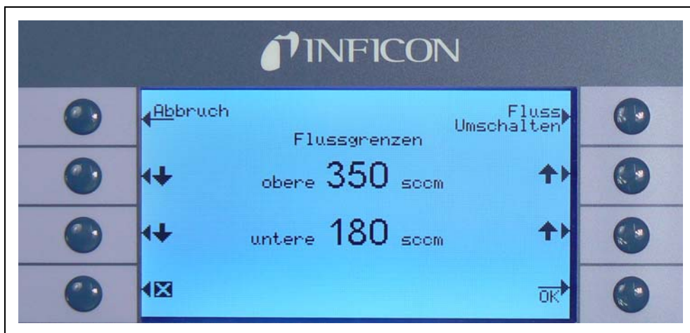
Fig. 49 Zmiana wartości granicznych przepływu (Flussgrenzen) dla przewodu czujnika SL3000
