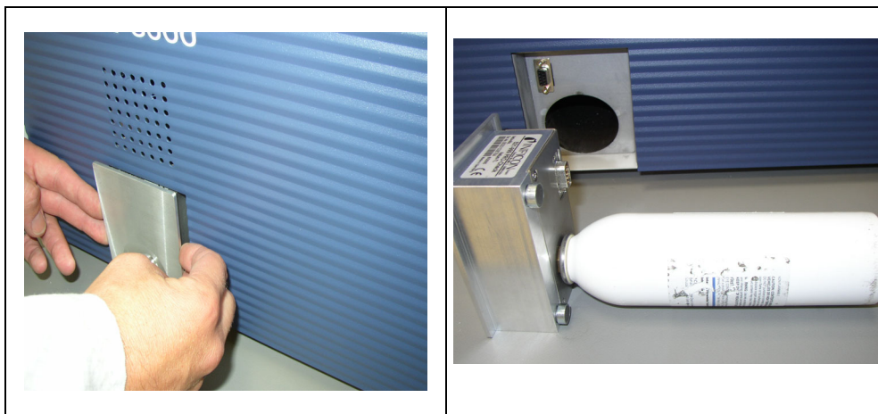
Fig. 84 Demontaż nieszczelności referencyjnej PRO-Check z urządzenia głównego
