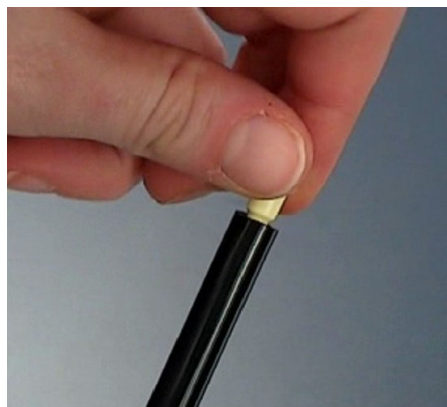
Fig. 72 Odkręcanie filtra kapilarnego
