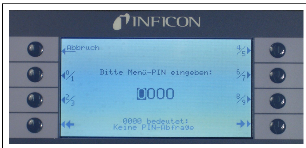
Fig. 53 Ustawianie kodu PIN menu dla zabezpieczenia parametrów
