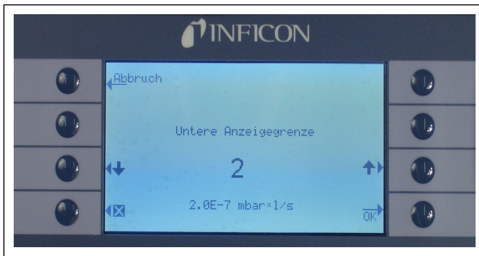
Fig. 47 Edytowanie dolnej granicznej wartości wskazania (Untere Anzeigegrenze)
