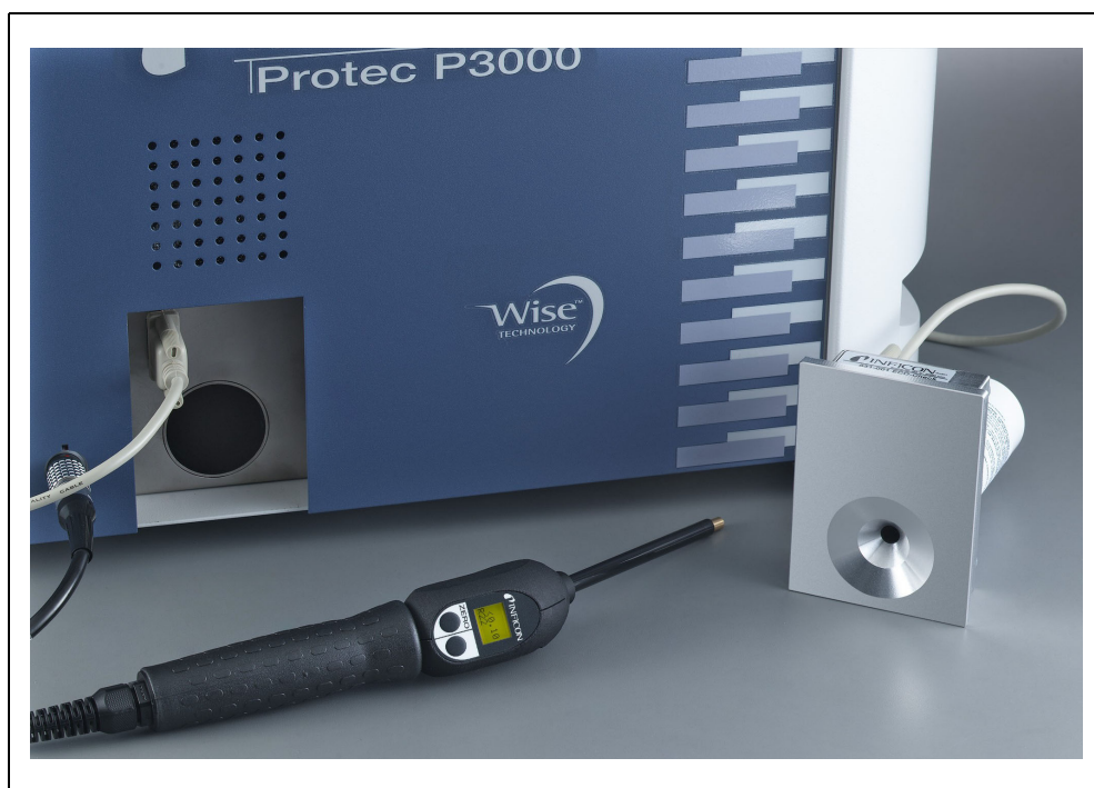
Fig. 14 Nieszczelność referencyjna PRO-Check zdemontowana z urządzenia głównego w celu użycia zdalnego
