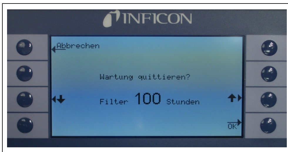
Fig. 61 Określanie częstotliwości KONSERWACJI (WARTUNG) dla filtra końcówki czujnika i jej zatwierdzenie
