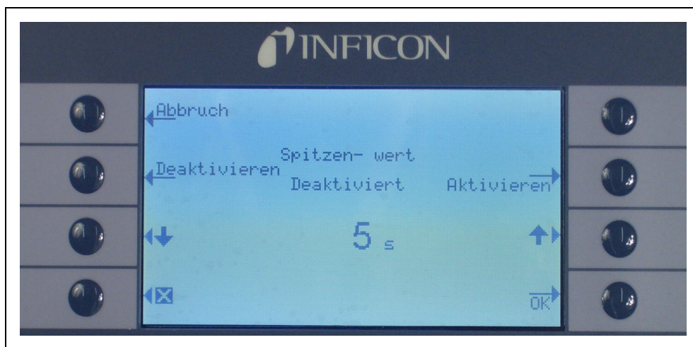
Fig. 55 Konfiguracja funkcji zatrzymywania WARTOŚCI SZCZYTOWEJ (SPITZENWERT)
