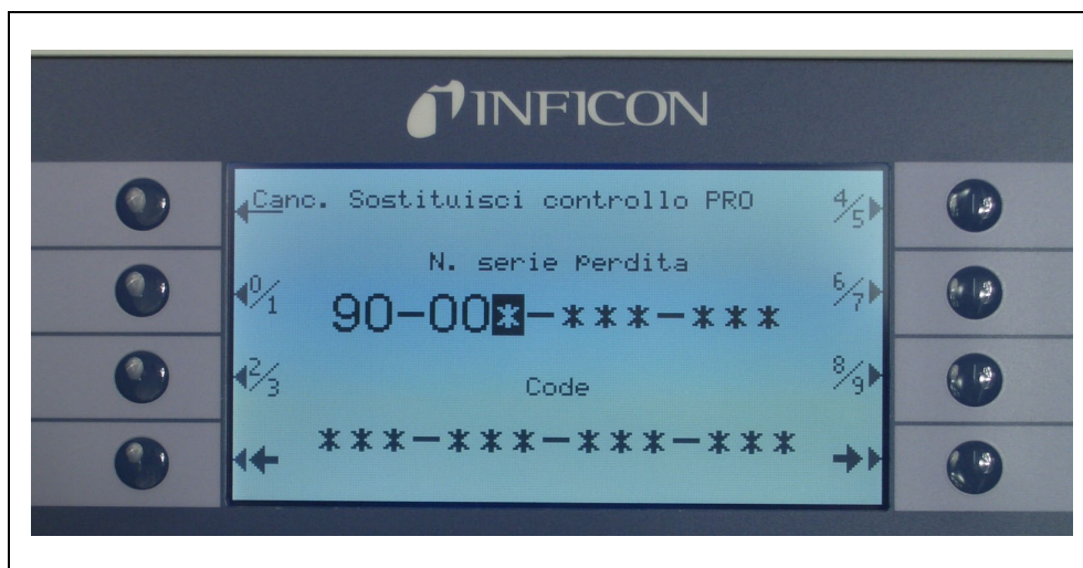
Fig. 4 Inicjalizacja nieszczelności referencyjnej PRO-Check
