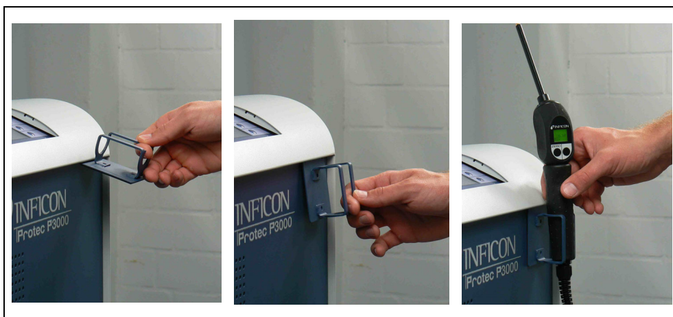
Fig. 7 Montaż uchwytu sonda
