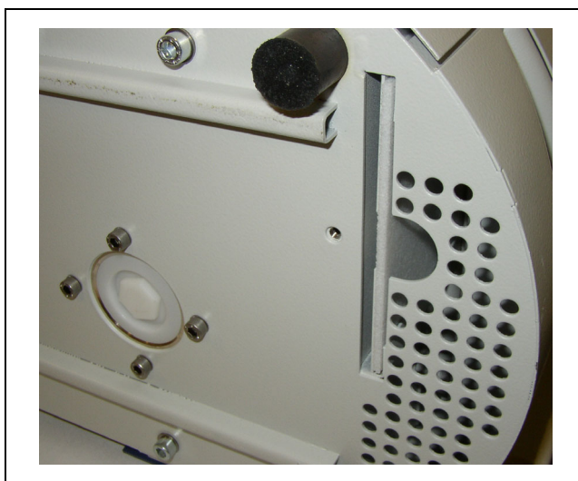
Fig. 70 Wyjmowanie filtra powietrza
