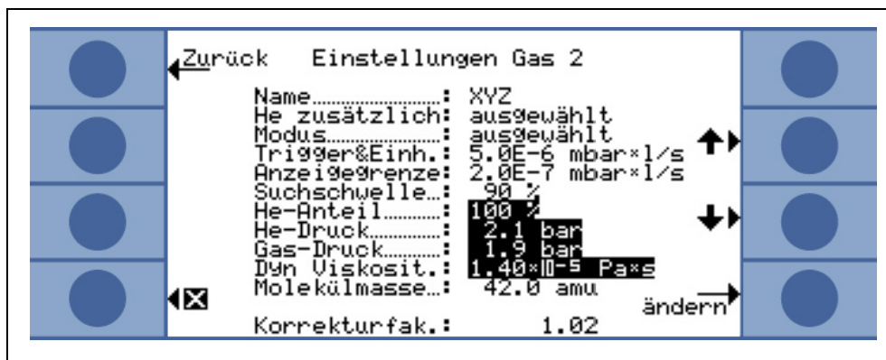
Fig. 44 Regulacja współczynnika korekcji czynnika chłodniczego dla gazu zdefiniowanego przez użytkownika
