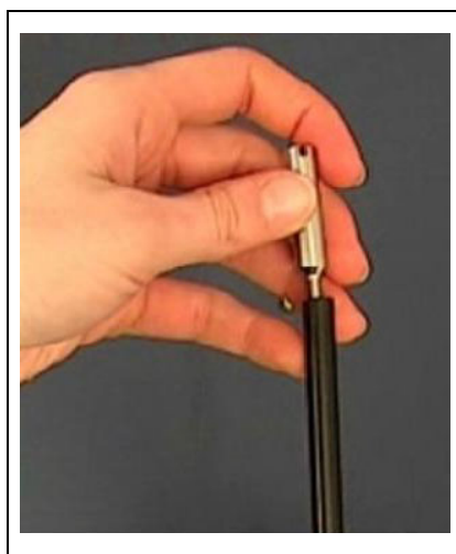
Fig. 3 Instalacja końcówki zabezpieczającej przed działaniem wody
