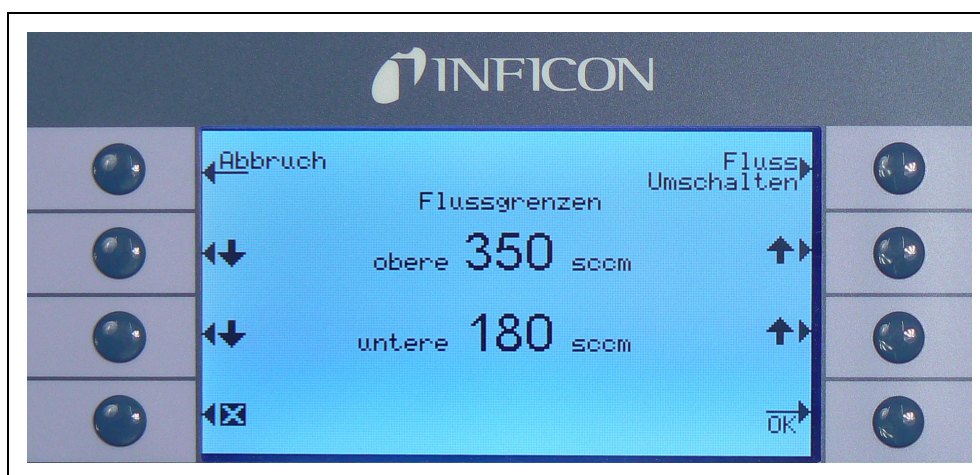
Fig. 49 Zmiana wartości granicznych przepływu (Flussgrenzen) dla przewodu czujnika SL3000
