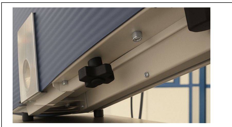
Fig. 2 Usuwanie zabezpieczenia transportowego przed uruchomieniem.
