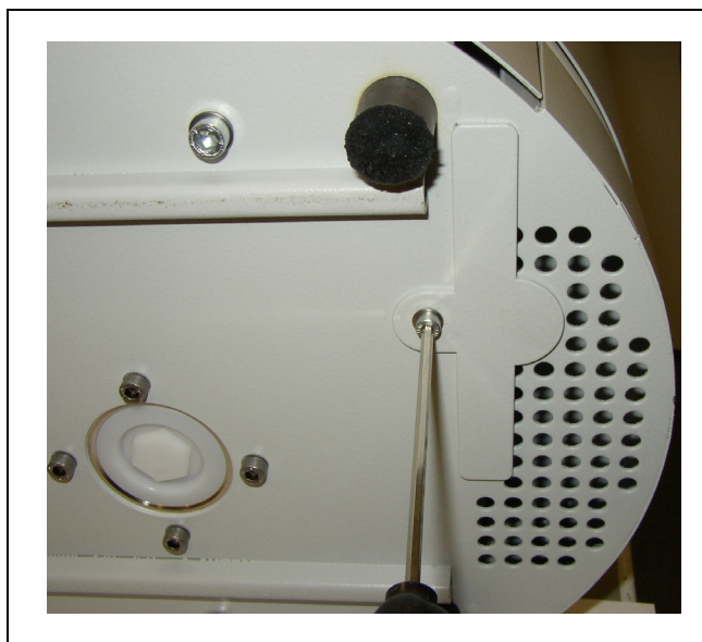
Fig. 69 Mocowanie filtra powietrza na spodzie detektora nieszczelności
