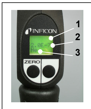
Fig. 20 Wyświetlacz na uchwycie w trybie standardowym
