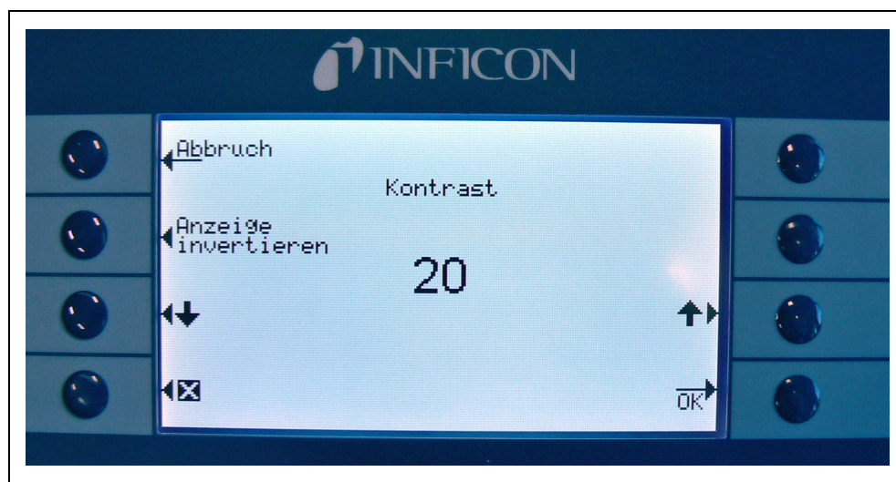
Fig. 54 Ustawianie kontrastu na wyświetlaczu głównym.
