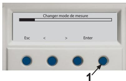
2. Poussez Entrée encore une fois pour sélectionner le **Mode analyse** ou poussez > pour sélectionner le **Mode détection** ou le **Mode combi**.
