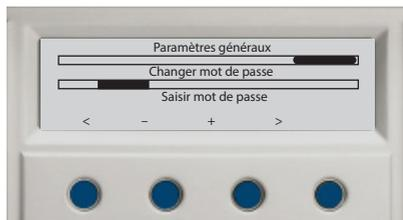
Si **Mot de passe erroné** est affiché à l'écran, poussez **Entrée** et inscrivez le mot de passe correct. Les menus seront accessibles jusqu'à ce que vous retourniez au **Mode Détection/ Mode Analyse**.
