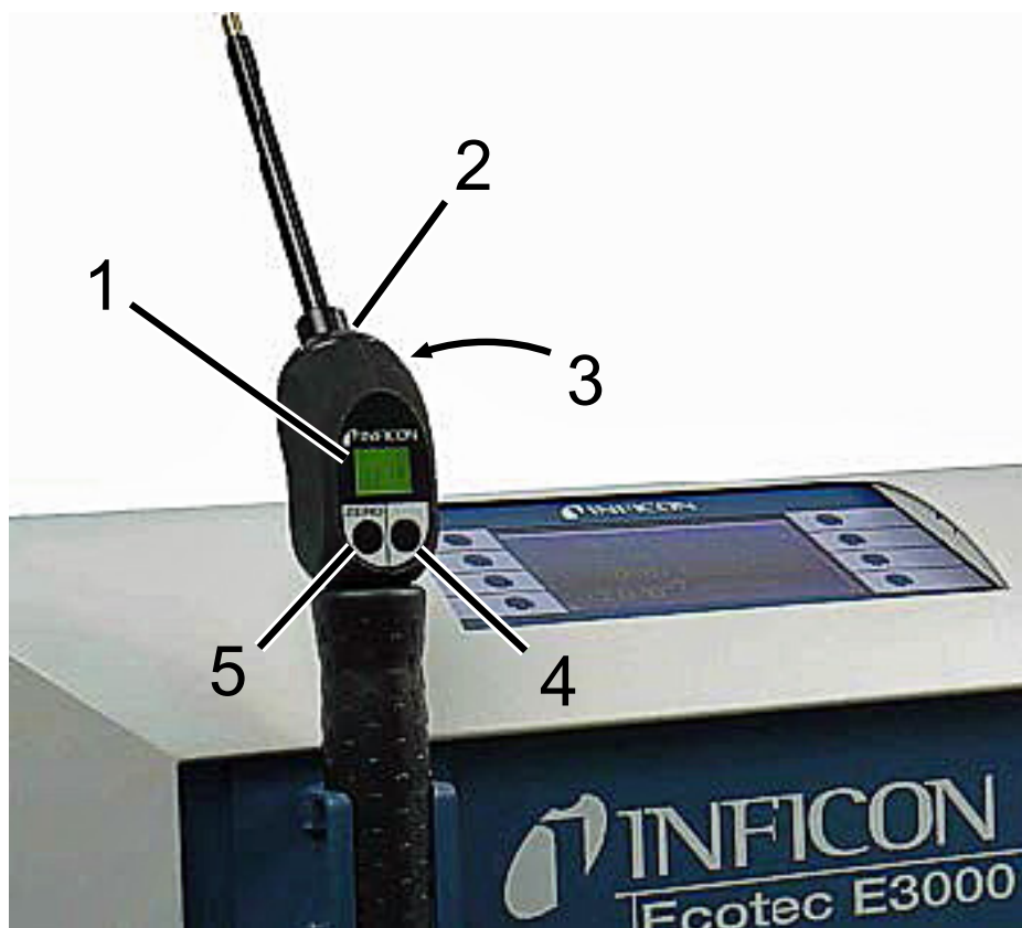
Fig. 4: Impugnatura sniffer: visualizzazione e funzioni
