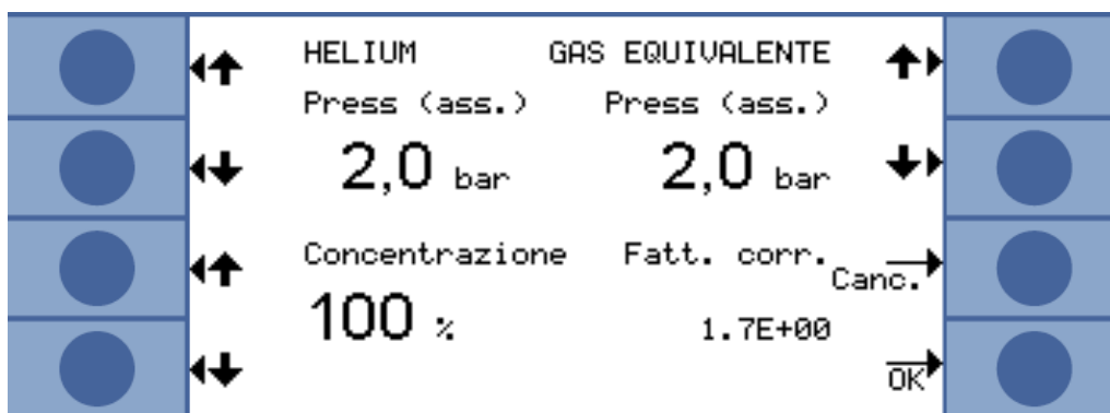
Fig. 27: Impostazione dei parametri per il gas equivalente e gas rarefatto
