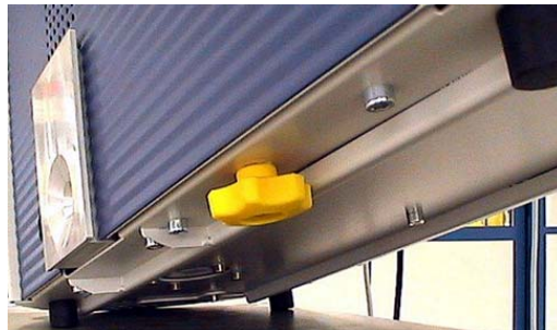
Fig. 5: Rimozione del fissaggio per trasporto giallo prima della messa in servizio
