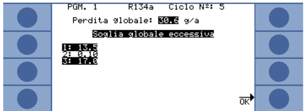
Fig. 36: Ricerca del gas R134a con il programma I•Guide 1: Il valore di attivazione e il tasso di perdita totale sono stati superati nei punti di misura 1 e 3.
