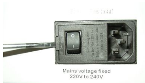
Fig. 50: Sollevamento del coperchio verso destra
