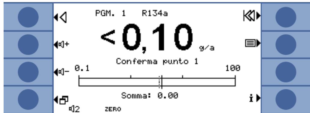
Fig. 32: Indicatore di misura in un programma I•Guide
