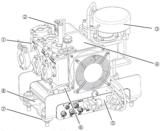
Fig. 1: Mass spectrometer module LDS3000
