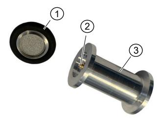
Fig. 4: Inlet module
