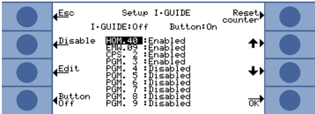
Fig. 37: Cycle counter reset
