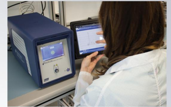
Semplifica l'analisi on-site grazie al display anteriore che permette il controllo dello strumento, i risultati dell'analisi e gli aggiornamenti di stato.
