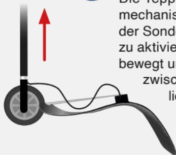
Die Teppichsonde verfügt über einen Arretierungsmechanismus (optional erhältlich), der das Anheben der Sonde über Hindernisse erleichtert. Um diesen zu aktivieren muss die Sondenstange nach vorne bewegt und leicht angehoben werden. Der Winkel zwischen Stange und Teppich sollte bei ca. 90° liegen. Um den Mechanismus wieder zu deaktivieren, setzen Sie die Teppichsonde mit etwas Kraft zurück auf den Boden.
